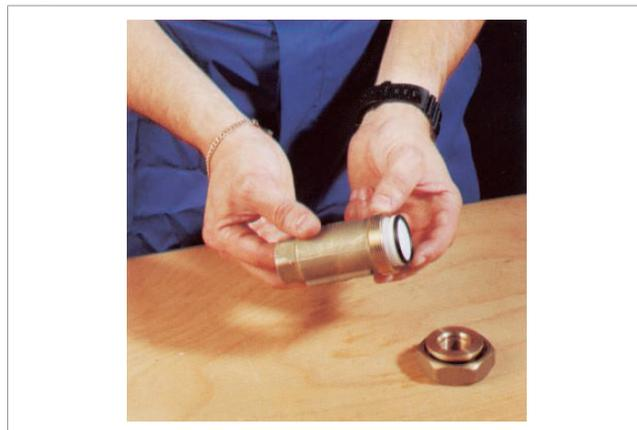
3) controllare che i due moduli di ritegno funzionino perfettamente; non devono esserci impurezze sulla sede di tenuta o sulla molla di chiusura. Nel caso in cui i moduli siano guasti, sostituirli.
