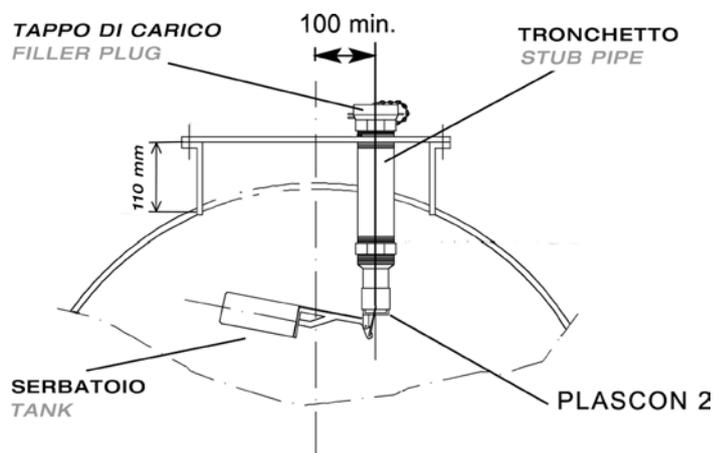
La valvola deve essere installata a 9/10 di altezza dal fondo del serbatoio, per tanto occorre conoscere la misura dell'altezza del serbatoio stesso; l'ultimo decimo di altezza è lo spazio riservato al tronchetto.
