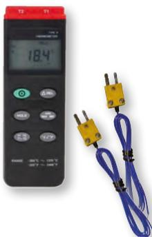
Termometro portatile con due ingressi digitale con display LCD, ingressi per termocoppia TC-K, funzione di massimo e data Hold, impostazione Offset sulle sonde e misura della temperatura differenziale tra le due sonde (T1, T2).
