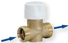
Valvole di zona utilizzate per intercettare o deviare fluidi termovettori su impianti di riscaldamento e raffreddamento. Sono particolarmente indicate nelle seguenti applicazioni: intercettazione di piccole utenze; intercettazioni automatiche di zone termiche, possono essere accoppiate ai collettori complanari; intercettazione di ventilconvettori a due e/o quattro tubi.
