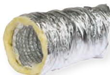
Realizzato in alluminio/poliestere microforato e materassino isolante in fibra di vetro di spessore 25 mm e densità 16 kg/mc e una protezione esterna anch'essa in alluminio/poliestere. Adatto a diverse tipologie di impianti civili ed industriali di ventilazione, condizionamento e riscaldamento.
