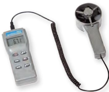
**ANALIZZATORE PER IMPIANTI DI CONDIZIONAMENTO E VENTILAZIONE**
