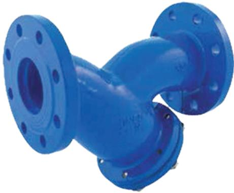
Vengono installati generalmente a monte di apparecchi, come scambiatori di condensa, riduttori, o regolatori di pressione, ecc.. per proteggere gli organi interni e di conseguenza garantire il buon funzionamento e una lunga durata degli stessi.
