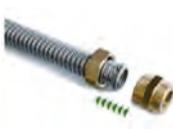
2. Applicare l'anello tra le ultime 2 onde del tubo ed avvitare il nipplo in modo da formare la battuta.
