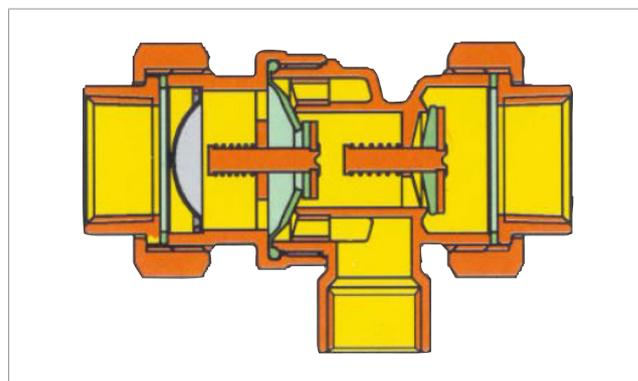
In caso di contropressione o depressione a monte, si apre il condotto di ventilazione collegato allo scarico e nel caso in cui il secondo ritegno sia ostruito per ragioni accidentali, l'acqua inquinata viene espulsa.
